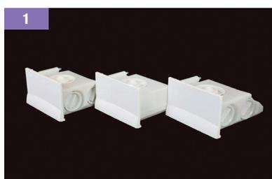
1 Preparare un serbatoio per contenere l'acqua della fresatura di **ceramiche vetrose** a base di silice; un serbatoio per contenere l'acqua della fresatura di **ossido di zirconio**; un serbatoio per contenere l'acqua pulita per lavare la pompa.
