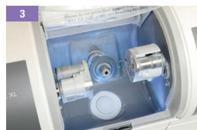
3 Poi, scrupolosamente sciacquare i residui di fresatura dal filtro della camera e la polvere di fresatura da sotto il filtro.
