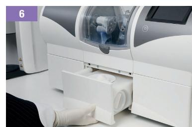
6 Rimuovere il serbatoio per il lavaggio e installare il serbatoio per l'**ossido di zirconio**. Poi, selezionare la modalità "fresatura ad umido" prima di iniziare a fresare. Utilizzare sempre acqua pulita nel serbatoio di lavaggio.
