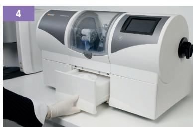
4 Rimuovere il serbatoio dell'acqua delle ceramiche vetrose e installare il serbatoio per il lavaggio con l'acqua pulita.
